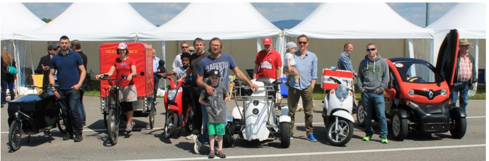
In sechs Durchgängen wurde von allen Fahrern und Fahrerinnen jedes Fahrzeug getestet. Der Parcours enthielt Hindernisse, die im Zustellalltag zu bewältigen sind, wie zum Beispiel Gehsteigkanten, Rampen, rutschige Straßenverhältnisse sowie eine unbefestigte Fahrbahn, enge Kurven, rasches Beschleunigen und scharfes Bremsen. Die Fahrzeuge waren mit Ladegut ausgestattet, das je nach Möglichkeit im jeweiligen Laderaum untergebracht war.
